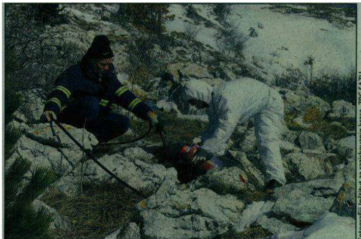
Injiciranje umetnega sledila v škraplje na pobočju pod Volovjo rebrijo.
